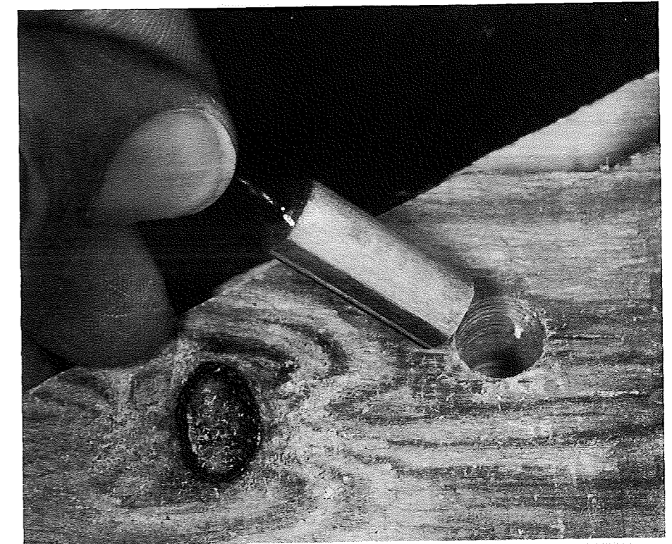
Figur 9. Prøveemne: Indboring af fugtmåledyvel.
